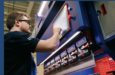
Управление обработкой заготовки реализовано в системе ЧПУ на русском языке. Удобный и понятный интерфейс позволяет быстро обучить оператора работе на станке. Управляющие программы разрабатываются непосредственно на рабочем месте на сенсорном мониторе. Осуществлена возможность удаленного обновления базы программ гибов и инструментов, перенос программ с одного станка на другой с использованием Flash-накопителя.
