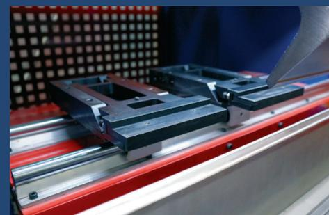
Система упоров представляет двухосевую конструкцию, включает в себя оси X и R в стандартной конфигурации и оснащена двумя или более задними упорами (в зависимости от длины станка), установленными на линейные направляющие.
