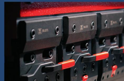
В стандартном исполнении оборудование оснащено механическим креплением пуансонов и матриц типа Amada (можно заменить на крепление типа Wila). Применение различных инструментальных систем и комбинаций инструментов не вызывает трудностей, что позволяет расширить диапазон сфер применения гибки. Возможен подбор опционального инструмента, в соответствии с требованиями заказчика.
