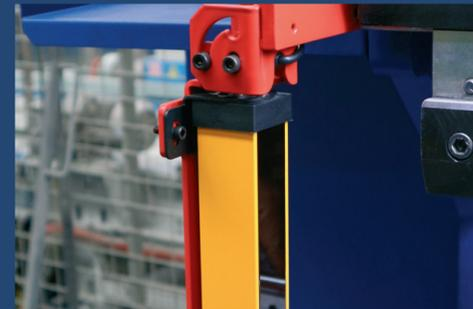
Система безопасности состоит из контроллера безопасности, концевых датчиков граничных положений всех осей, концевых датчиков закрытия внешних защитных ограждений, лазерного барьера безопасности, а также системы контролирования усилий на всех приводах, что позволяет полностью контролировать корректность работы станка и производить блокировку движения при возникновении внештатных ситуаций, включая повреждения проводки на контролируемых элементах управления.
